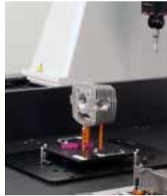
K551218: Toepassing van Mitutoyo eco-fix
